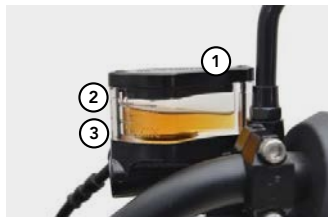
Delantero: 1. Depósito de freno delantero 2. Línea de marca del límite superior MAX 3. Línea de marca del límite inferior MIN
